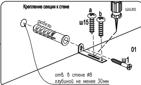
1. По угольнику разметить положение отверстия под дюбель в стене
