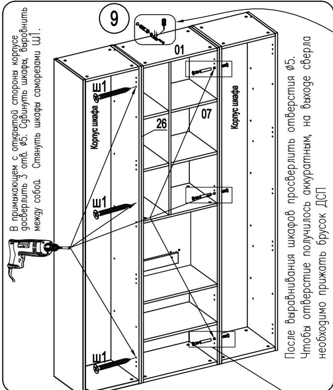
В прилегающем с открытой стороны корпусе досверлить 3 отв. Ø5. Сдвинуть шкафа, выровнять между собой. Снять шкафа саморезами Ш1.
